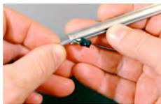
2. Inserir o cabo da fechadura na ranhura do fuso, conforme exibido. Depois, deslizar o cabo pelo comprimento da ranhura.
