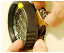
14. Empurrar o anel do teclado de volta contra a base e girá-lo no sentido horário até ele se encaixar com um estalido. Testar o funcionamento da fechadura, no mínimo, com a porta aberta antes de fechar o cofre.
