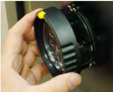
13. Para instalar a bateria, puxar a aba do teclado para fora ligeiramente e girar o anel do teclado no sentido anti-horário. O anel irá sair da base uma distância o suficiente para exibir o conector da bateria. Prender a bateria e colocá-la no compartimento de bateria.
