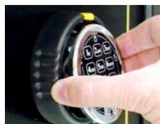
11. Mantendo o cabo da fechadura e o cabo da bateria em seus respectivos compartimentos, colocar o teclado sobre a base. A parte superior é assentada na base primeiro e, depois, a parte inferior.
