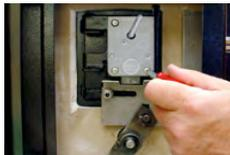
4. Colocar a extremidade do cabo da fechadura pela porta do cofre a partir do interior. Puxando delicadamente o cabo, inserir a fechadura com o fuso preso pela porta do cofre para que ela possa ser presa à placa de montagem da porta com os três parafusos fornecidos.
