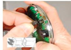
8. Encaixar o cabo da fechadura no receptáculo preto na parte posterior do teclado. Observe que existem dois sulcos elevados no plugue do cabo e duas ranhuras correspondentes no receptáculo do teclado. Alinhar estes recursos antes de inserir o plugue no receptáculo.
